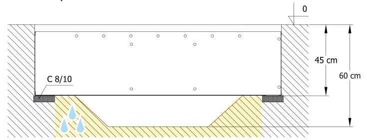
Drained undersoil / Podłoże wodopzepuszczlane / Дренажная подсыпь
